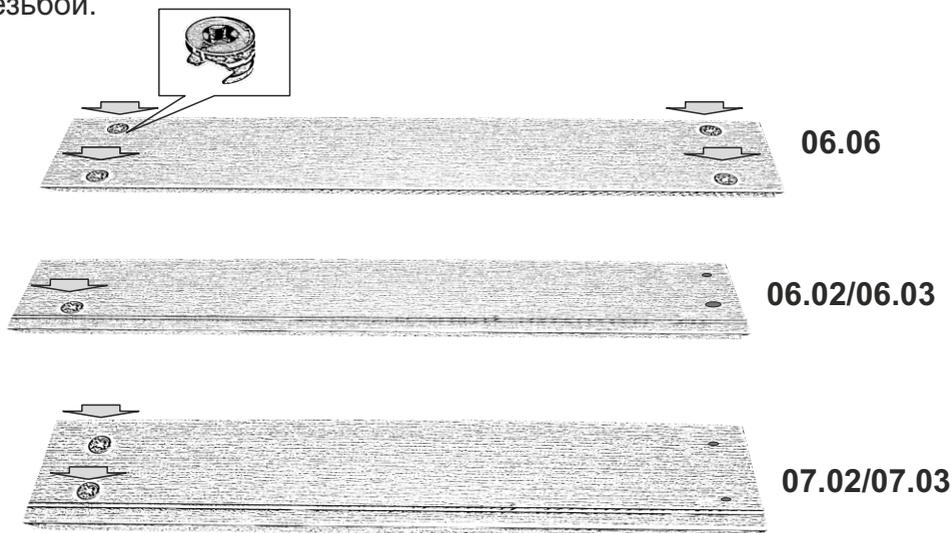
В отверстия на пласти стенки соединительной 05.06, боковых стенок ящика 06.02/06.03, 07.02/07.03 установить эксцентрики.
