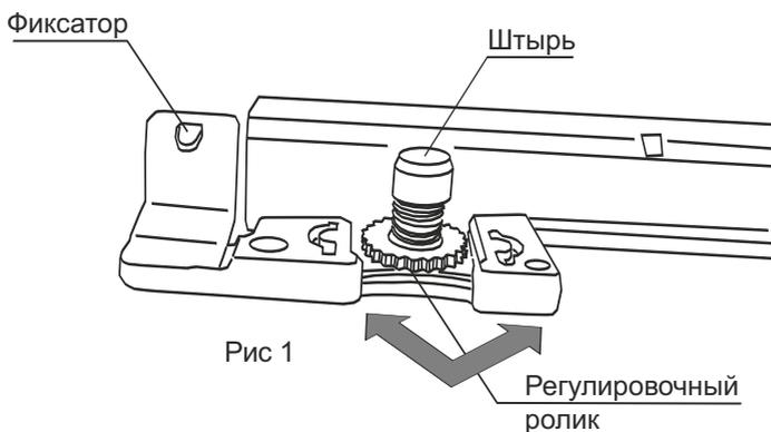
Отрегулировать зазоры между ящиками, между ящиками и крышкой и нижним горизонтальным, вращая регулировочный винт влево-вправо, согласно Рис 1.
