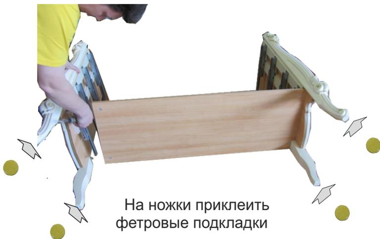
Установить собранную конструкцию на ножки. В пазы стенок вертикальных 02 и 03 и стенки горизонтальной 04 вставить заднюю стенку 05.
