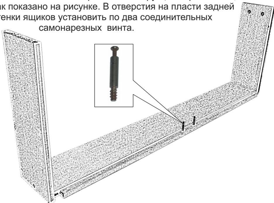
На соединительные винты задней стенки ящиков установить стенку соединительную и зафиксировать на эксцентриковую стяжку. Установить заглушки.
