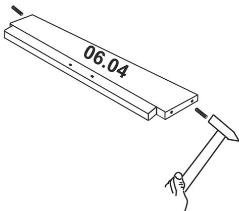
В кромку задней стенки ящика 06.04 установить 2 шканта 6x30
