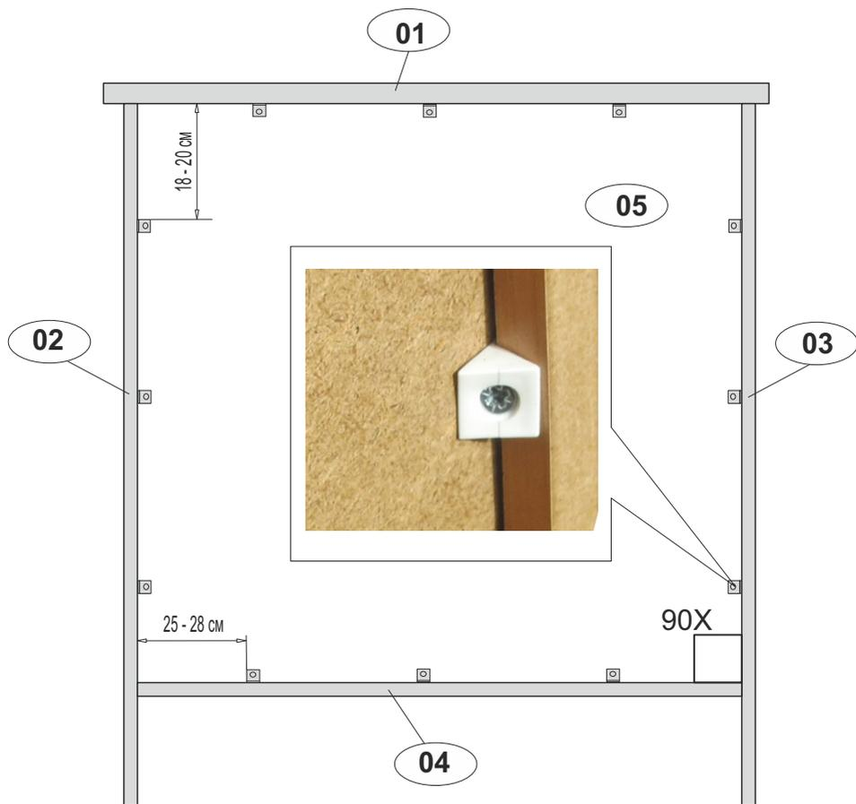
Крепить заднюю стенку 05 к крышке 01, стенке горизонтальной 04, стенкам вертикальным 02 и 03 на соединитель задней стенки шурупами при помощи отвертки.
