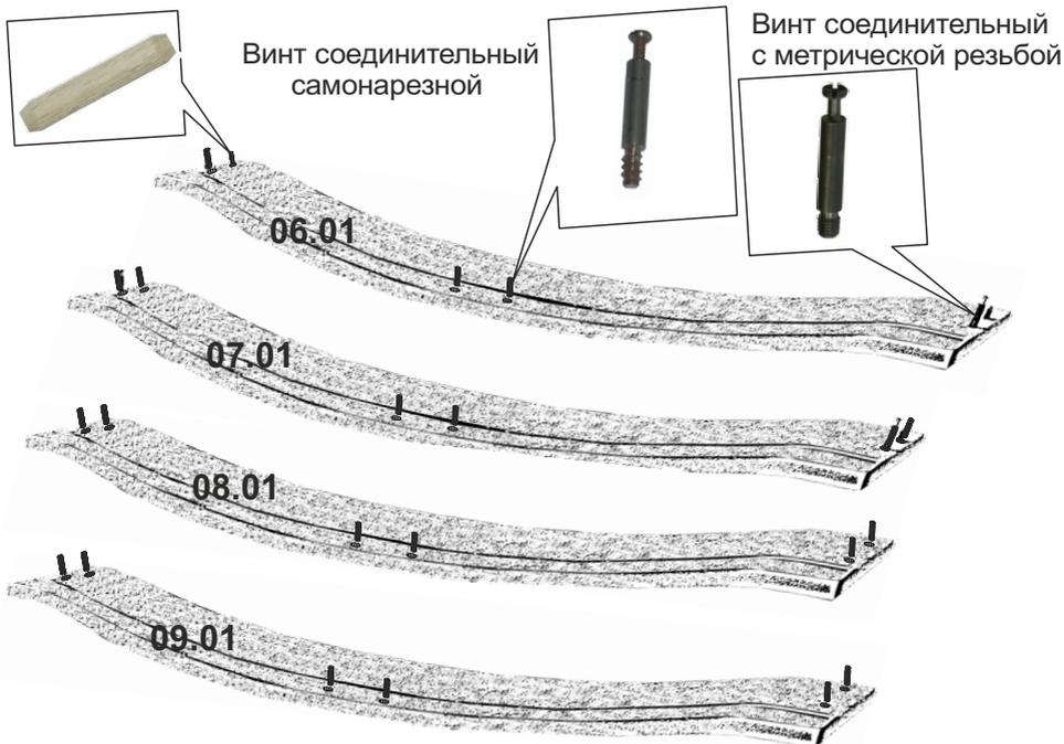
В отверстия узкой передней стенки ящика 06.01 вставить два шканта 6x30 и ввернуть два соединительных винта самонарезных и два соединительных винта с метрической резьбой. В отверстия передних стенок 07.01, 08.01 и 09.01 ввернуть по два соединительных винта самонарезных и четыре соединительных винта с метрической резьбой.
