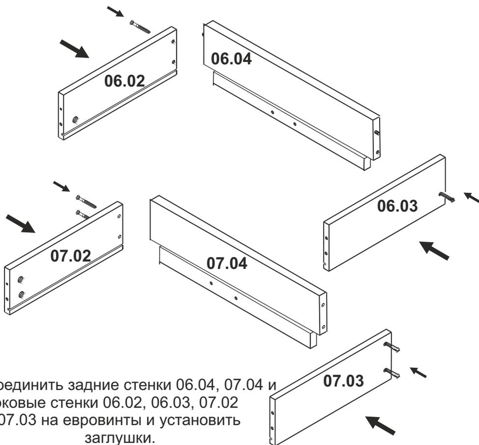
Соединить задние стенки 06.04, 07.04 и боковые стенки 06.02, 06.03, 07.02 и 07.03 на евровинты и установить заглушки.
