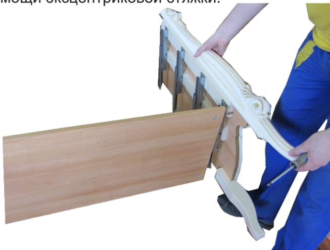
К собранной конструкции крепить левую вертикальную стенку 02 при помощи эксцентриковой стяжки.
